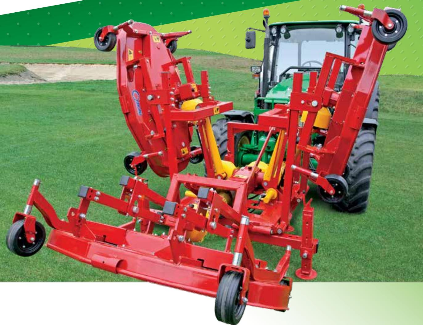
Mit einer Schnittfläche von 3,60 bis gut 5,65 m bringt MULTICUT ein Vielfaches an Leistung und reduziert dabei gleichzeitig Mähzeit und Unterhaltungskosten für Sportplätze, Park- und Golfanlagen, insgesamt also sämtliche größeren Grünflächen, für die der Mäher ursprünglich auch entwickelt wurde.
