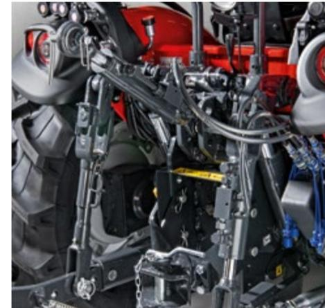
**HYDRAULISCHE HUBSTREBE UND DREIPUNKT\***
