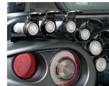
**HINTERE SCHNELLANSCHLÜSSE MIT EBENER STIRNSEITE**
