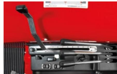
**KRAFTHEBER MIT ZUGKRAFT- UND LAGEREGELUNG**
