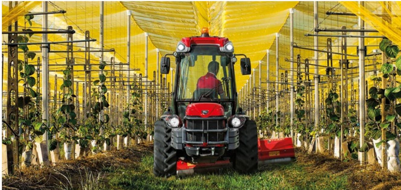
Das in den Kotflügeln integrierte Beleuchtungssystem verfügt über Leuchteinheiten mit Reflexionsparabel für eine besonders große Leuchtweite auf die frontale Fahrspur, das Arbeitsgerät und das umliegende Feld. Durch die komplette Öffnung der Motorhaube und die problemlose Abnahme der Seitenteile und des Batteriedeckels gehen die Wartungseingriffe einfach und schnell von der Hand.
