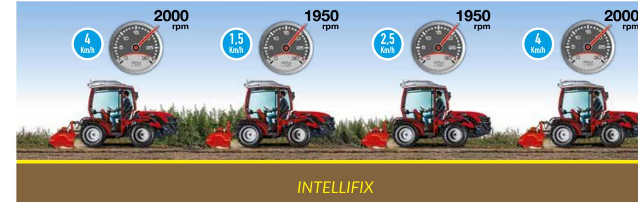
**INTELLIFIX** > dient zum Erreichen des vorgegebenen maximalen Drehmoments, sobald eine zusätzliche Leistungsaufnahme durch die Zapfwelle anfällt. Die Geschwindigkeit wird nach und nach gesenkt, um die Leistungsabgabe konstant zu halten.
