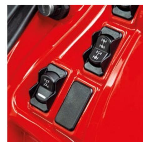
Die Sperre der hinteren Differenziale verhindert den Raderschlupf und optimiert die Traktion. Das Ausschalten des Vorderradantriebs ist bei Straßenfahrten nützlich und verhindert die Beschädigung von empfindlichen Böden.
