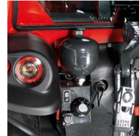
Hydropneumatische Aufhängung mit automatischer Drucksteuerung.
