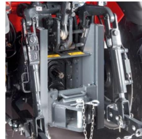
Mit schnell verstellbarem Slider\*-Zughaken wird die Anbauhöhe des gezogenen Geräts optimal eingestellt.
