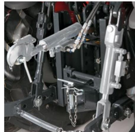
Senkrechte, hydraulische Zugstange und ein dritter Punkt\* ermöglichen die praktische Einstellung vom Bedienerplatz aus.
