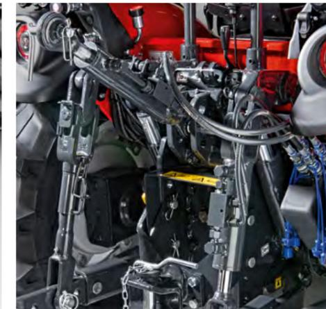
**HYDRAULISCHE HUBSTREBE UND DREIPUNKT\***
