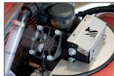
Im Tank integrierte Pumpe
