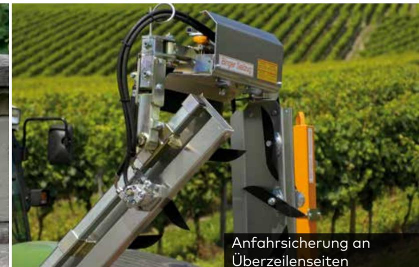
Die Modelle AC 3, AU 3 und AU 3V bieten eine manuell verstellbare Schnittbreite. Die AU-Modelle verfügen serienmäßig über eine Winkelverstellung und einen Anfahrtschutz der äußeren Schneidbalken.
