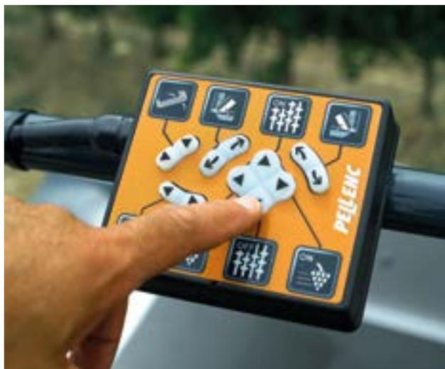
Fernbedienungen zur Steuerung der Öffnung aller Komponenten des Erntekopfs (Abbeerer, Sortierer, Kippen der Behälter)
