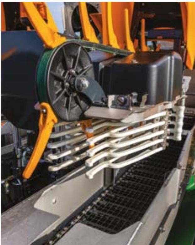
Lineare Abbeermaschine mit 5 langen Fingerpaaren
