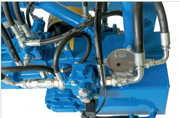
Autonome Ölversorgung für die Feintastautomatik
