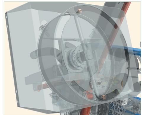
So funktioniert's - die durch den Verdichter erzeugte Luft wird durch die Rotoren geführt und trifft auf die äußeren und inneren Blätter der Laubwand. Der gewünschte Entlaubungsgrad lässt sich durch Rotationsgeschwindigkeit der Rotoren, Fahrgeschwindigkeit und Abstand zur Laubwand einstellen.
